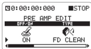
Cet écran permet d'activer/désactiver ("ON/OFF") le module d'effet, de sélectionner son type ("TYPE") et de contrôler un paramètre d'effet (autres éléments).
